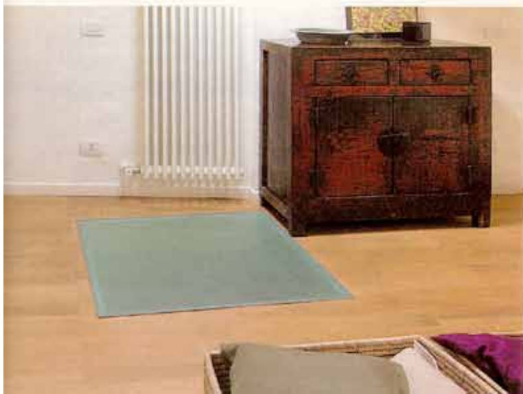
Nel sopralco, l'illuminazione artificiale è risolta con lampade a risparmio energetico su cui sono montati portalampade in lamiera verniciata. Questa zona, a sua volta, fornisce luce al bagno sottostante attraverso un inserto in cristallo realizzato nel pavimento.
